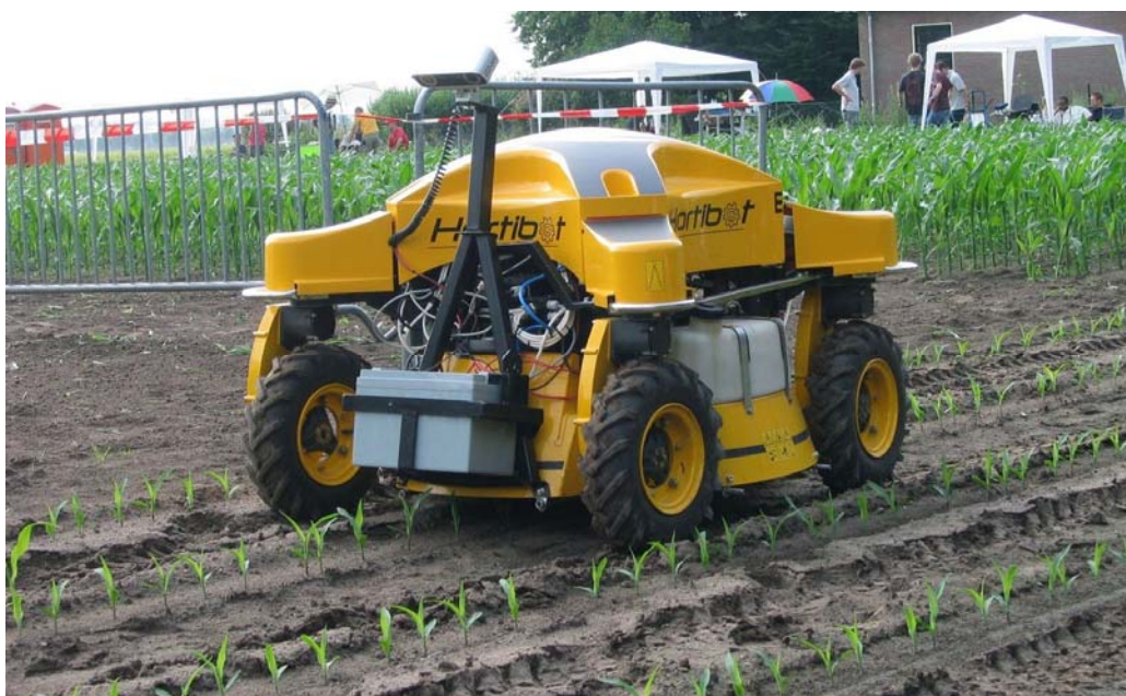
Figur 4 "Hortibot" er en automatisk ukrudtsrobot, der effektivt kan kontrollere ukrudt (kilde: www.hortibot.dk )
