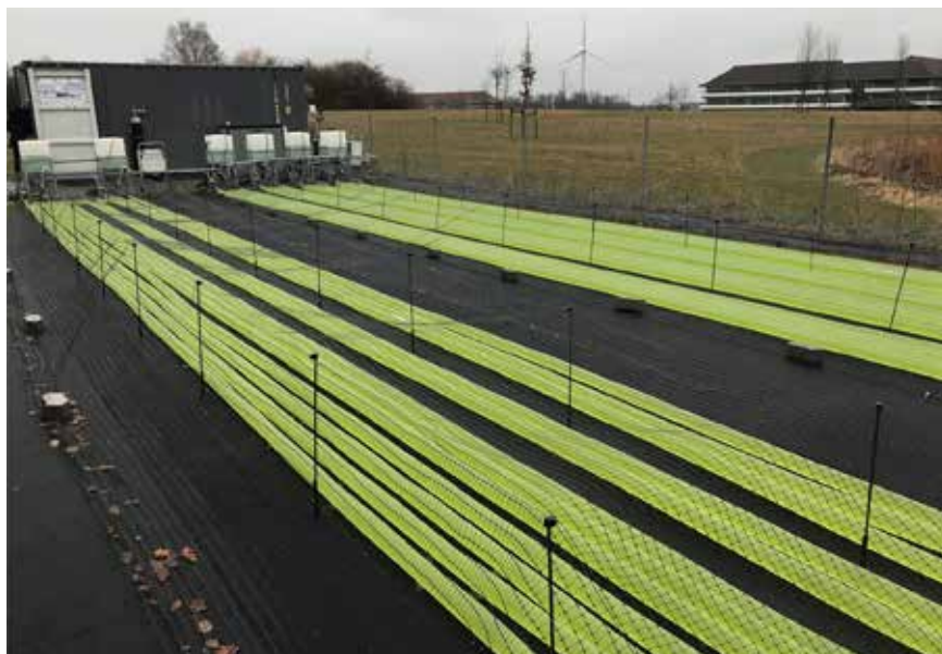
Opstart af algedyrkning i en såkaldt fotobioreaktor på Teknologisk Institut.
